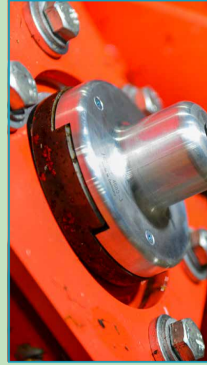
Sikkert hold ved hjelp av innsatte magneter
