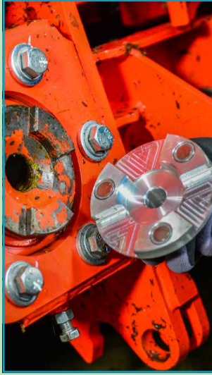
Verktøy med profil som passer til hurtigkoblingen
