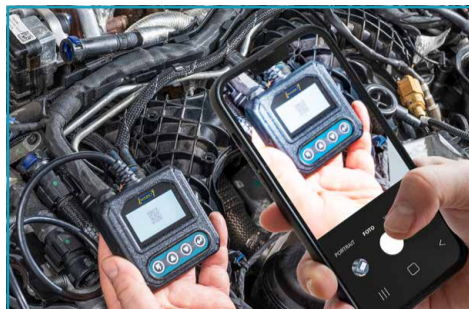
Generering av QR-koder for deling av testresultater på smarttelefon/nettbrett
