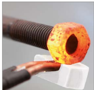
Løsne rustne bolter
